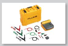
Kit de test d'isolement 5 kV Fluke 1550C
